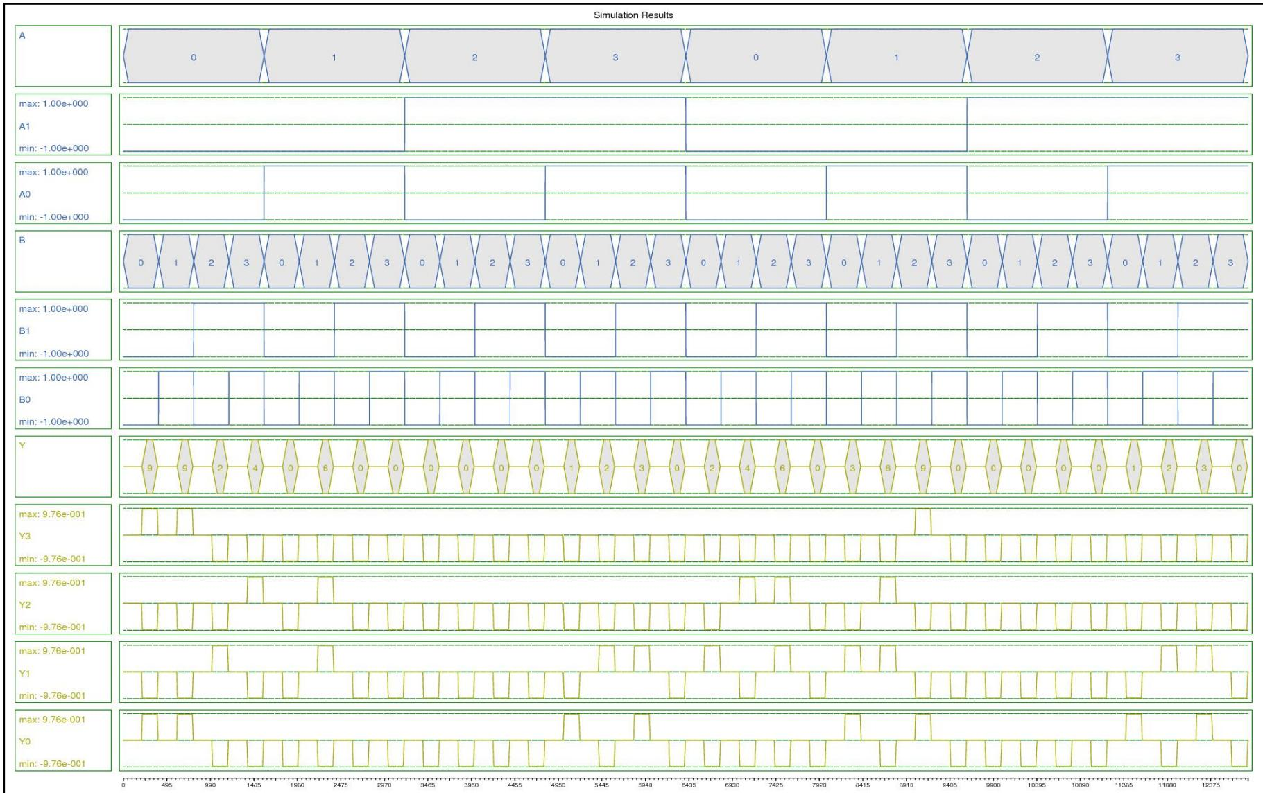
Iz rezultatov je razvidno, da množilnik pravilno deluje. Rezultat se na izhodu pojavi z zakasnitvijo sedmih urinih period. Kot je značilno za QCA arhitekturo množilnik deluje cevovodno. To pomeni, da lahko vhod nastavimo vsako periodo, in tudi rezultati bodo izstavljeni vsako urino periodo, z zakasnitvijo sedmih.
