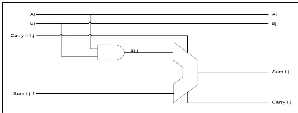
Z eno celico lahko realiziramo eno-bitni množilnik, in sicer, tako da operanda pripeljemo na vhoda  $A_i$  in  $B_j$ , vhodna Carry in Sum postavimo na '0', izhodna bita pa dobimo na izhodih Sum(LS) in Carry(MS).
