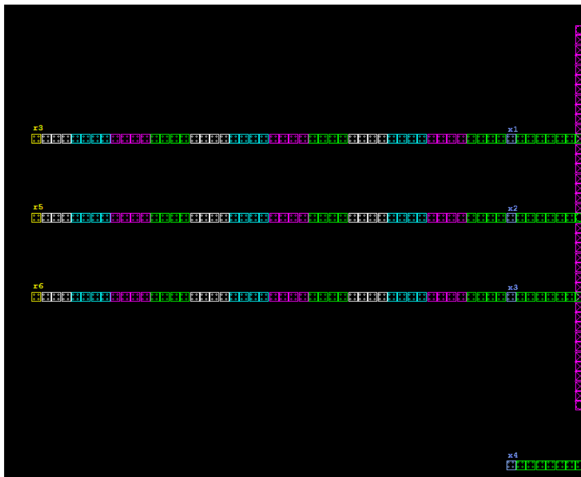
Slika 9: QCA realizacija kodirnika – levi del strukture
