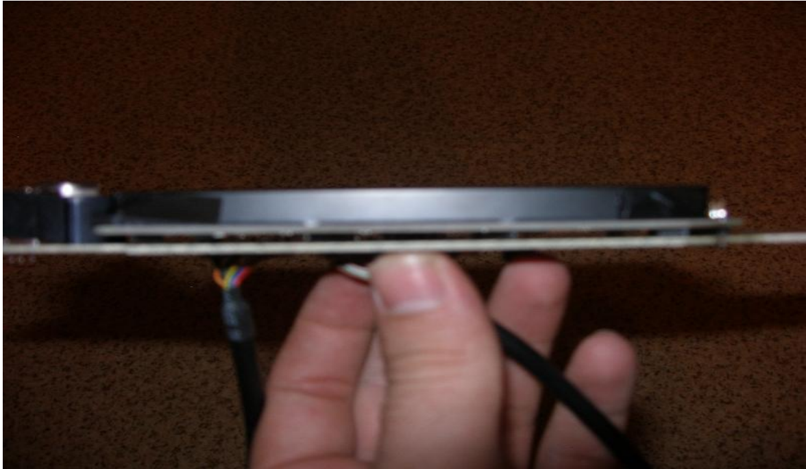
Slika 3.1-5 Stranski pogled na sprednjo ploščo – tukaj je lepo vidna „sendvič“ vezava zgornjega in spodnjega dela vezja
