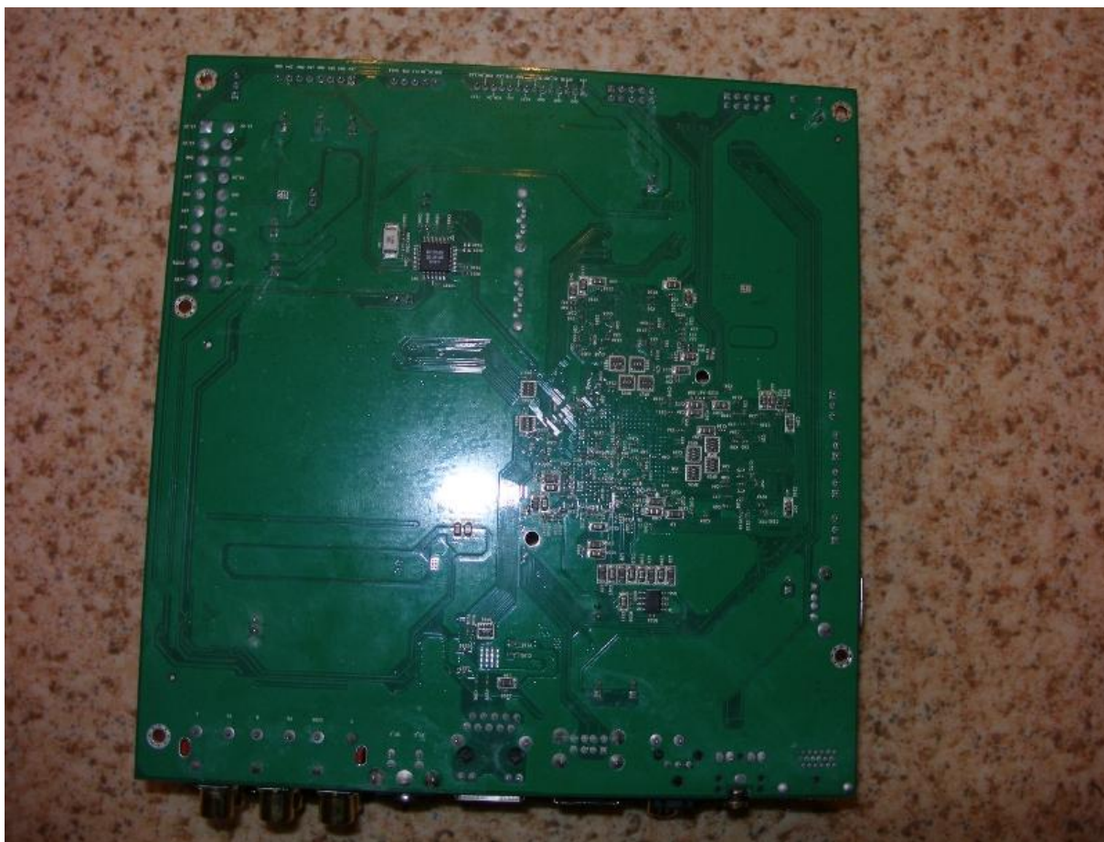
Slika 3.1-8 Spodnji del matične plošče
