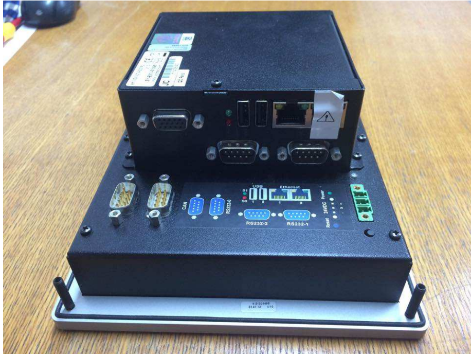
Slika 5.3: Janztec emVIEW 6T/A500/R3, zadnji del s strani.
