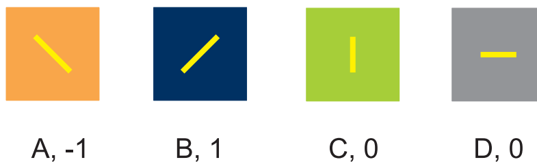
Slika 3.4 Slika prikazuje celice razširjenega QCA-ja, ki določajo stanja A, B, C, D. Poleg stanj je podana logična vrednost, ki jo stanje določa. Slika prikazuje tudi vsa stabilna stanja, ki jih definirata dva elektrona znotraj posamezne QCA-celice. Vsa druga stanja so nestabilna [5].
