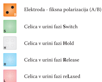
Slika 17. Pomen kvantnih celičnih struktur uporabljenih v modelih dvojiških pomnilnih celic.
