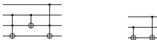
Slika 4.5 : Levo je samostojno prikazana ena ponovitev prenosa (carry), desno pa vsote (sum)
