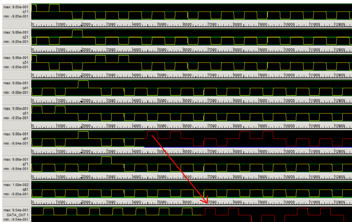
Slika 11: Izhodni signali za DATA OUT 1 po plasteh in kočen izhodni signal DATA OUT 1.
