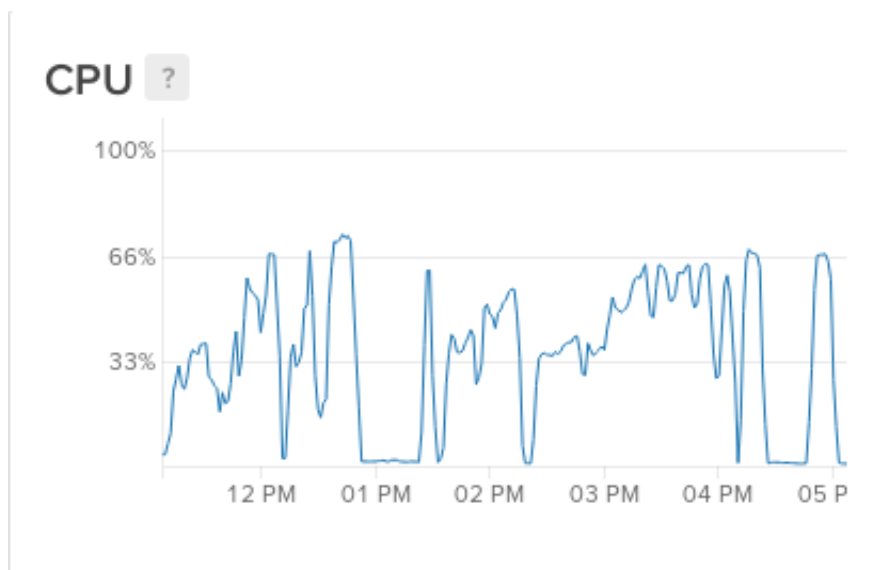
Slika 1.9: Graf porabe procesorja v času poganjanja testov za meritve 1.7.1 in 1.7.2.
