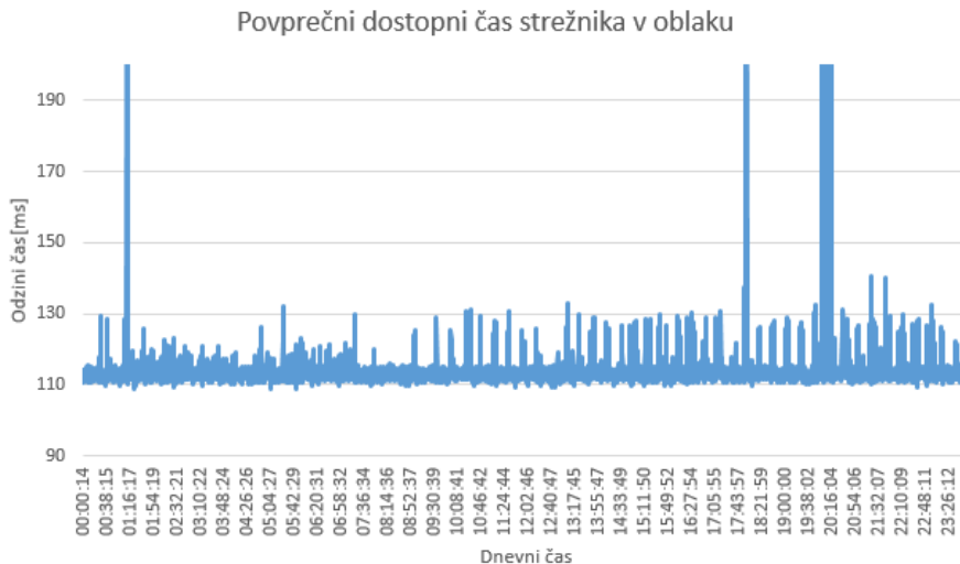
Slika 1.3: Testiranje odziva strežnika, Digital Ocean Virtualni strežnik.
