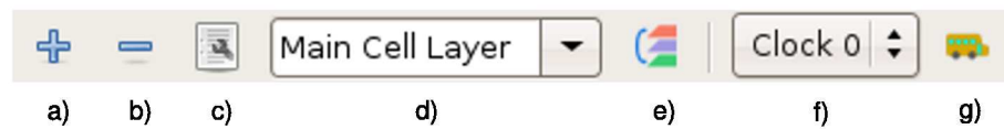
Slika 3.4 Ikone za delo s plastmi ter dve pogosto uporabljani funkciji. Nahajajo se v vodoravni orodni vrstici in vodijo do naslednjih bližnjic: ikona a) omogoča ustvarjanje nove plasti, ikona b) odstranjevanje obstoječe plasti, ikona c) omogoča nastavljanje lastnosti plasti, ikona d) priključuje padajoči meni za izbiro plasti, ikona e) omogoča razvrščanje plasti, ikona f) priključuje padajoči meni za nastavljanje urinega področja, ikona g) pa omogoča grupiranje celic v vodilo.
